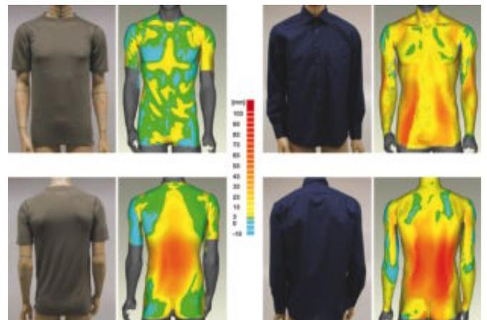
Mit Hilfe der neuesten Generation von Bodyscannern macht die Empa die Kontaktflächen von enger und weiter Bekleidung sichtbar – ein wichtiges Element für die zukünftige Forschung Richtung «Design for Function».
